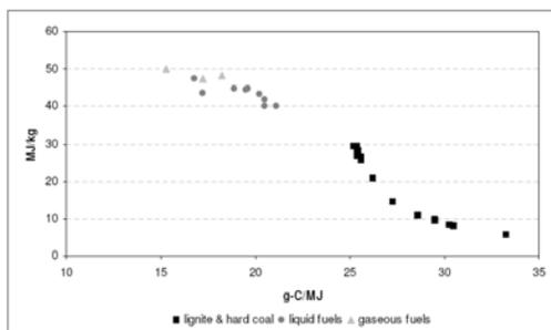
نمودار (۱): ارتباط بین ارزش گرمایی سوخت و مقدار کربن [۱۱]
